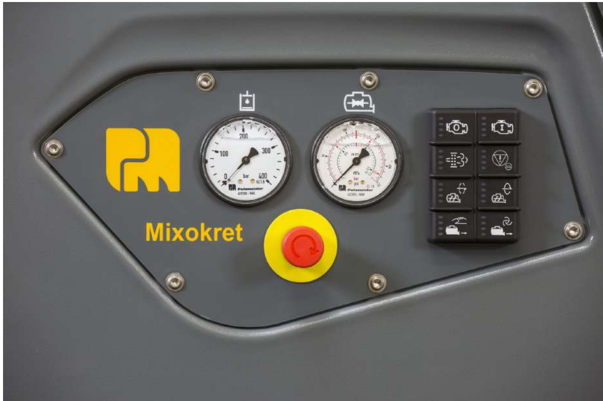
Przejrzyście rozmieszczona centrala Mixokreta - Dwa manometry, wyłącznik awaryjny i klawiatura
